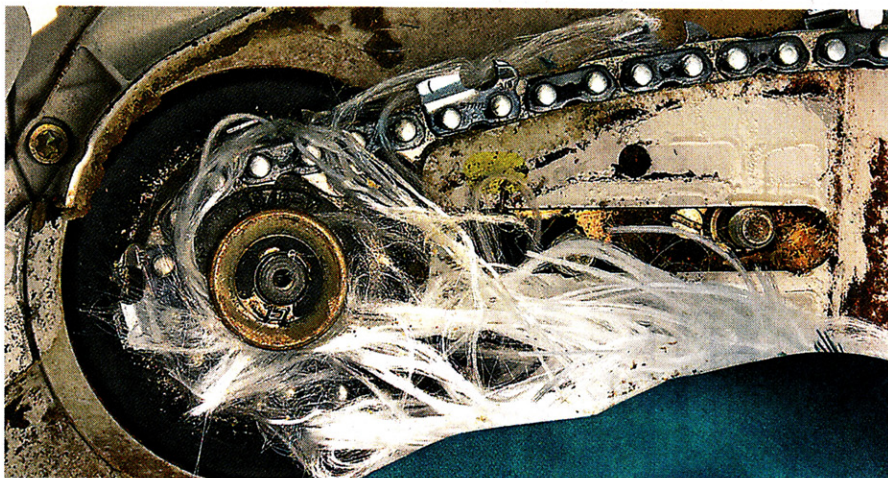
Bremse: Gerissene Fasern aus dem Hosenbein stoppen das Antriebsrad
